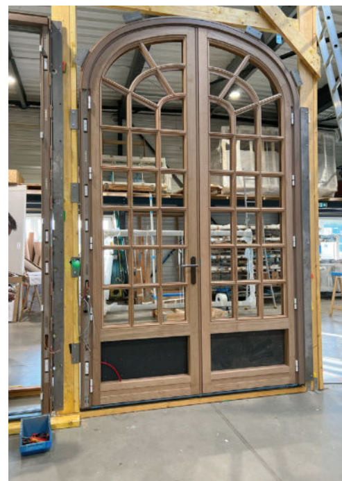
Daucalis : fabrication de menuiseries monumentales retard effraction classe RC4 équipées de serrures motorisées pour un hôtel particulier.
