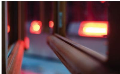
**Étape 1 :** les menuiseries sont accrochées sur un convoyeur. On applique un premier traitement au flow coat : la préservation (insecticide et fongicide).
