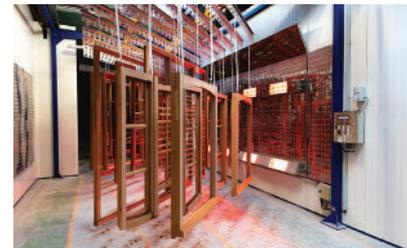
**Étape 2 :** les menuiseries sont envoyées dans un second flow coat pour la réalisation du traitement hydrofuge. Ces deux premières étapes permettent de les protéger contre les agressions extérieures et de les préserver des dégradations dans le temps.
