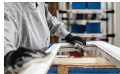
**Étape 4 :** les menuiseries arrivent devant le poste égrenage. Elles sont alors décrochées et égrenées manuellement c'est-à-dire poncées légèrement. L'égrenage permet d'obtenir un excellent état de surface avant l'application de la couche de finition peinture pour un rendu esthétique optimal.
