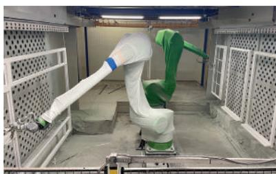
**Étape 5 :** les menuiseries sont raccrochées et passent dans une deuxième cabine pour application de la finition. Avec ses cinq pompes, le robot permet de changer aisément de couleur au gré des commandes..
