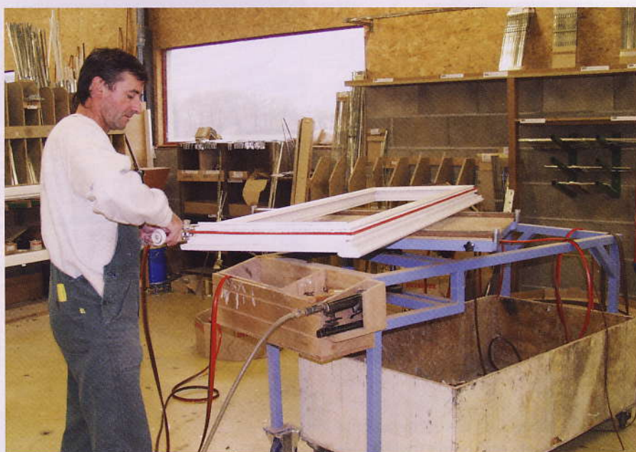
Le double joint d'isolation thermique posé manuellement.
